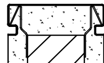
Befestigung mit Nagelanker fissaggio da tassellare/immurare su muratura fitting with screw/fixing on concrete wall
