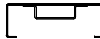
Befestigung mit Hutanker fissaggio con staffa ad "U" fitting with "U" bracket
