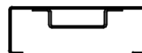
Befestigung mit Hutanker fissaggio con staffa ad "U" fitting with "U" bracket
