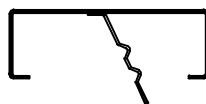
Befestigung mit Maueranker fissaggio con zanca a muro fitting with anchor for concrete
