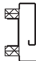
Montage auf Gipswand montaggio su parete in cartongesso fitting on stud/gypsum wall
